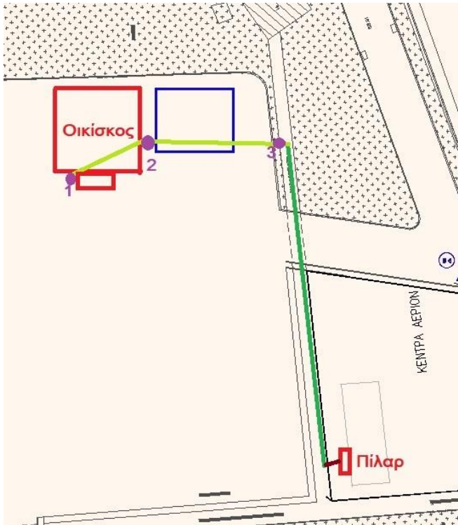
Εικόνα 1. Ενδεικτική όδευση καλωδίου
